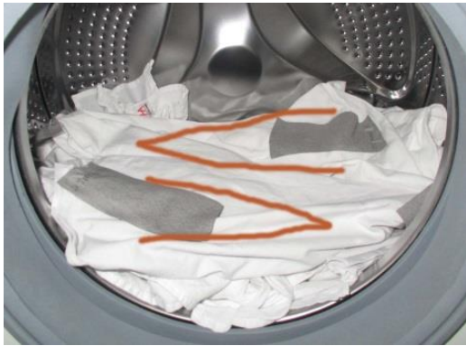
图 C. 14 附着污染布的衬衫的装载
